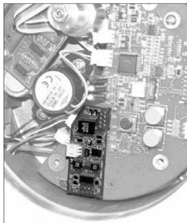
Рисунок 24. Плата аналогового выхода 4 – 20 мА.
