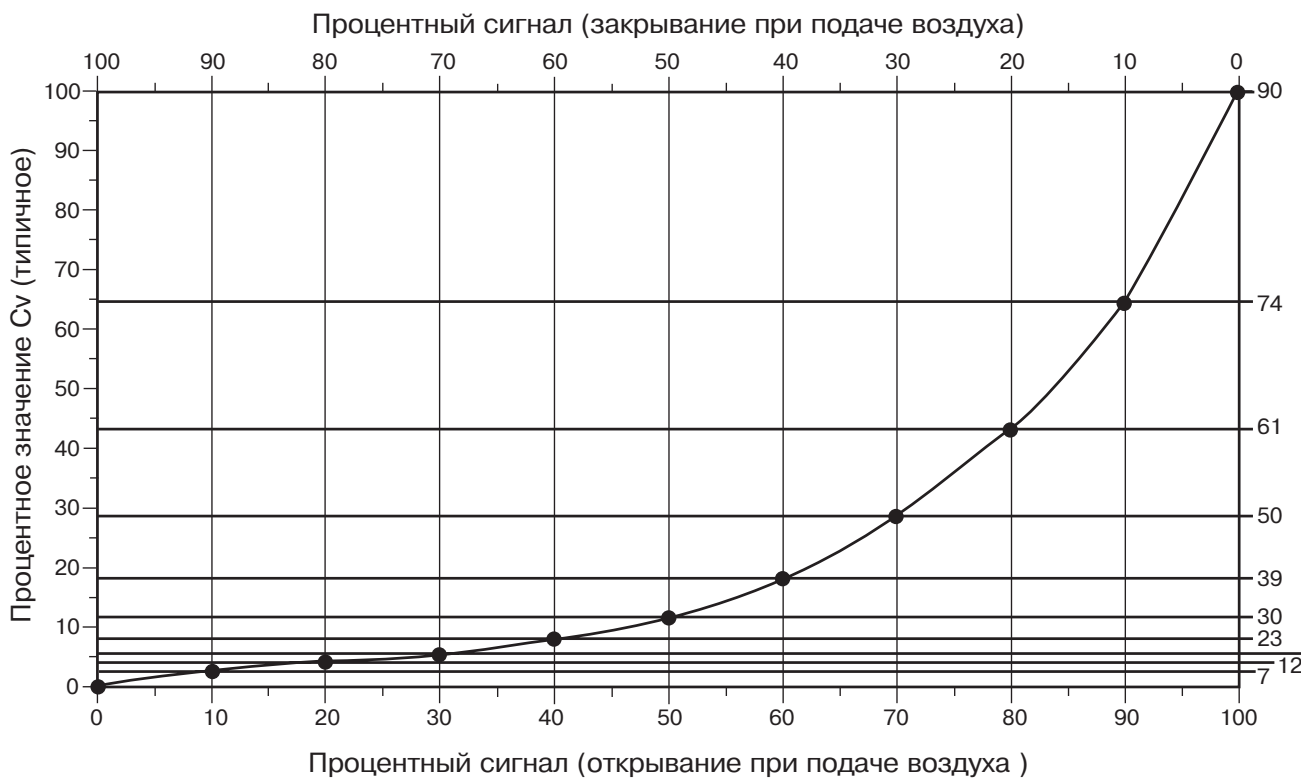
Рис . 13 . ShearStream – равнопроцентная гидравлическая характеристика (зависимость поворота вала от приборного сигнала )
