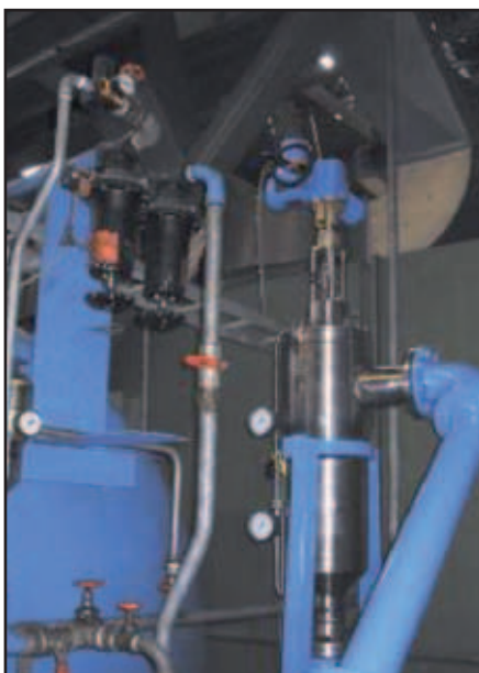
图 2: 运行中的多级 Z 型阀门
