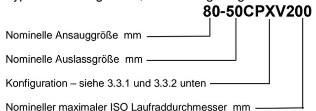
Die obige typische Nomenklatur ist eine allgemeine Erklärung der CPXV Konfigurationsbeschreibung. Die tatsächliche Pumpengröße und die Seriennummer sind auf dem Typenschild der Pumpe angegeben. Kontrollieren Sie, dass diese mit der entsprechenden mitgelieferten Zertifizierung übereinstimmen.
