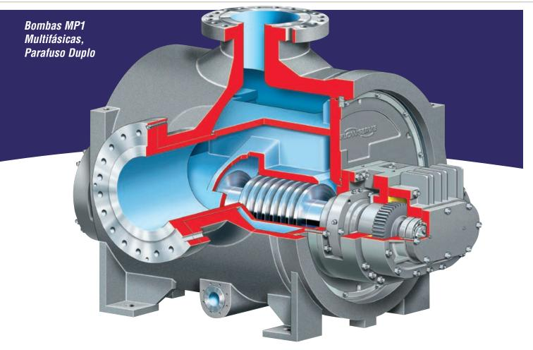
A MP1 da Flowserve é a bomba de parafuso duplo mais robusta da indústria de petróleo e gás. Projetada para bombeamento multifásico, possui uma configuração de dupla sucção e dois parafusos sincronizados, atendendo à última edição da API 676. O projeto da MP1 foi ainda mais refinado para proporcionar alta eficiência global e níveis de vibração mais baixos do que qualquer outra bomba multifásica de parafuso duplo.
