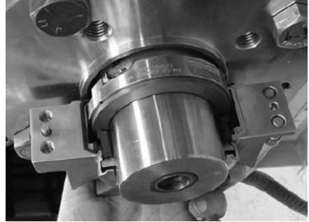
Assemblage du fouloir
