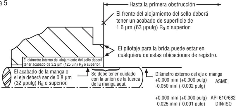
Aunque el PSS 4 se diseñó para una aplicación industrial agresiva y para tener facilidad de instalación, es necesario hacer el ensamblado en un entorno limpio de acuerdo con los siguientes pasos de instalación. No se requieren dimensiones ni medidas de ajuste para instalar el sello. El sello de la PSS 4 cuenta con dispositivos de ajuste y centrado para asentar el sello correctamente.
